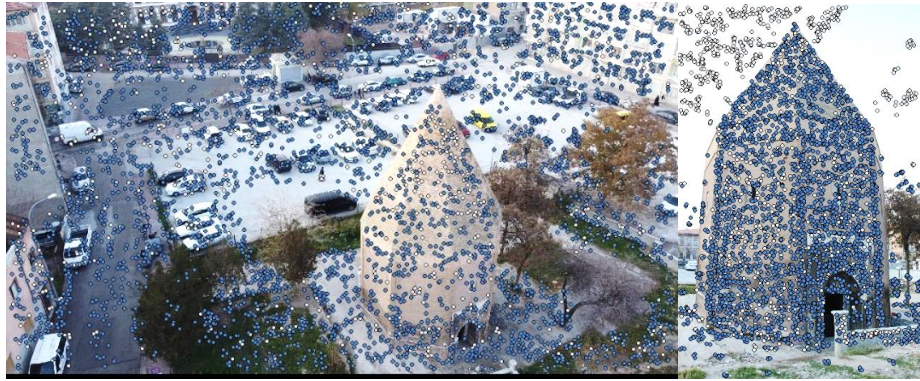
Şekil 81. İHA ile alınan görüntü (sol) ve Fotoğraf makinesi ile alınan görüntü (sağ) üzerinde program tarafından tespit edilen bağlantı noktalarının konum ve sayısı
