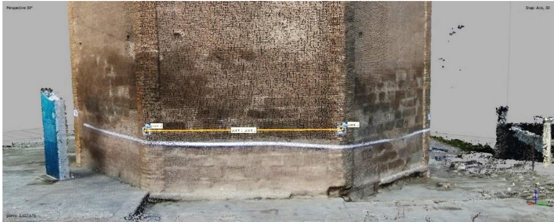
Şekil 55. İşaretçi noktalar arasında referans ölçü (3.80m) girilmesi
