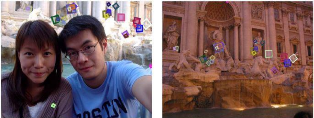
Şekil 38. Ölçeği-değişmez dönüşüm özellikli noktaların farklı zamanlarda kaydedilmiş görüntülerde tespit edilmesi
