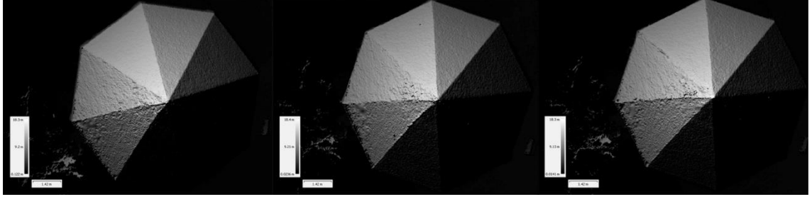
Şekil 93. Farklı ışık değerlerindeki görüntülerden oluşan modellerden elde edilen derinlik haritaları, (sol)orijinal, (orta)poz artan, (sağ)kontrast ve doyum artan
